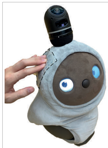
図4: ロボット用の柔らかい電子人工皮膚(破線部)。
