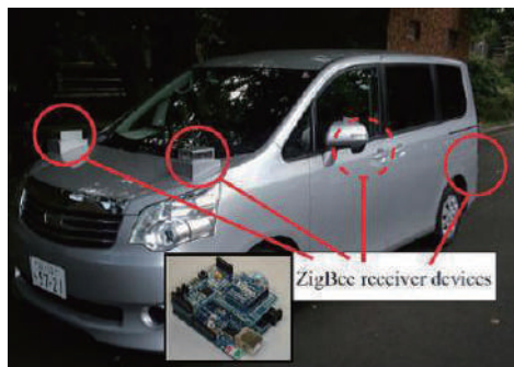
図1: 実験用車両に車載カメラ、GNSS、Gyro、Zigbee送受信機を搭載し、自動運転の総合的研究に活用しています
